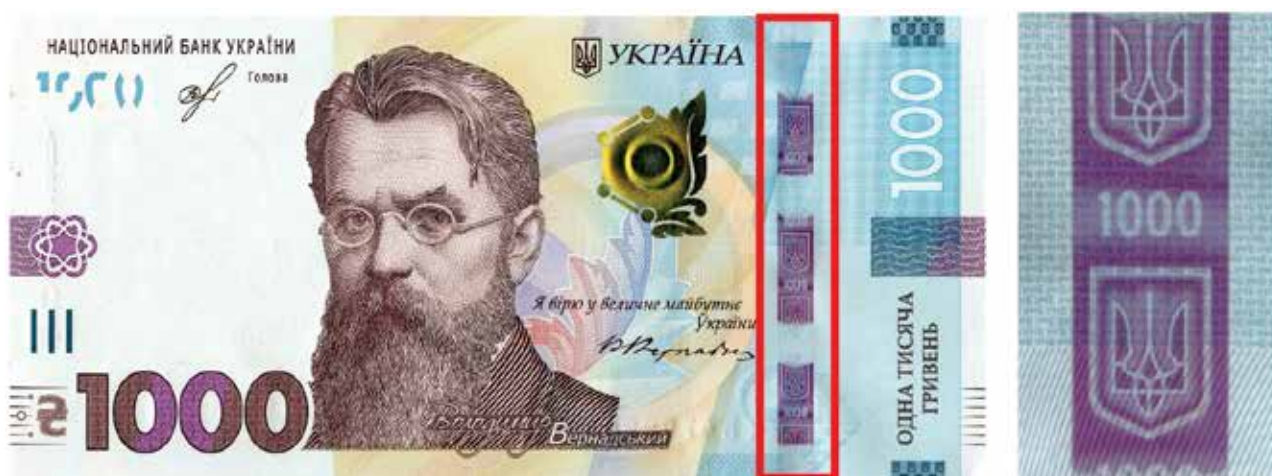
Рис. 3. Захисна полімерна стрічка на банкноті номіналом 1000 грн
