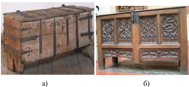
Рис. 2. Формування корпусів: а) із дощок; б) рамкової конструкція із тахлею
